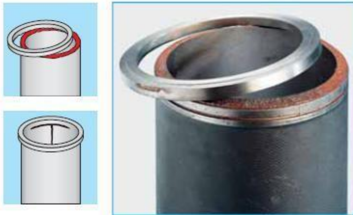
Figura 6. Rotura de collarines de camisa.
