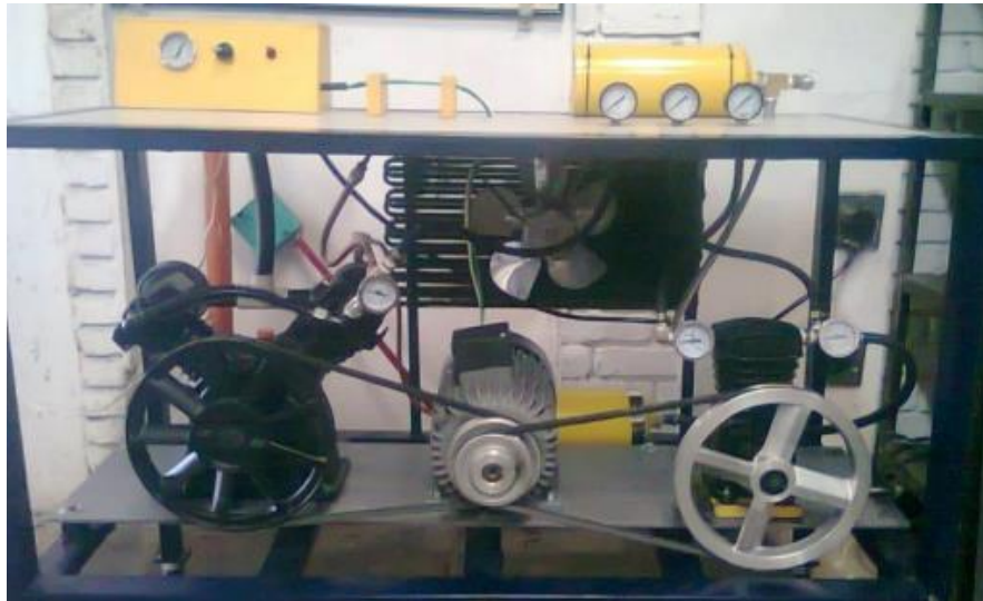
Figura 14. Antiguo Banco de Compresores.
