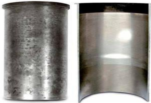
Figura 7. Desgaste irregular del cilindro.
