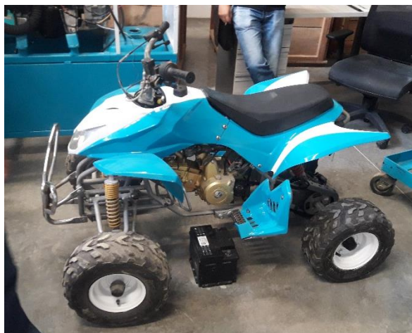
Cuatrimoto. Tanque de combustible roto, carburador y llantas en mal estado.
