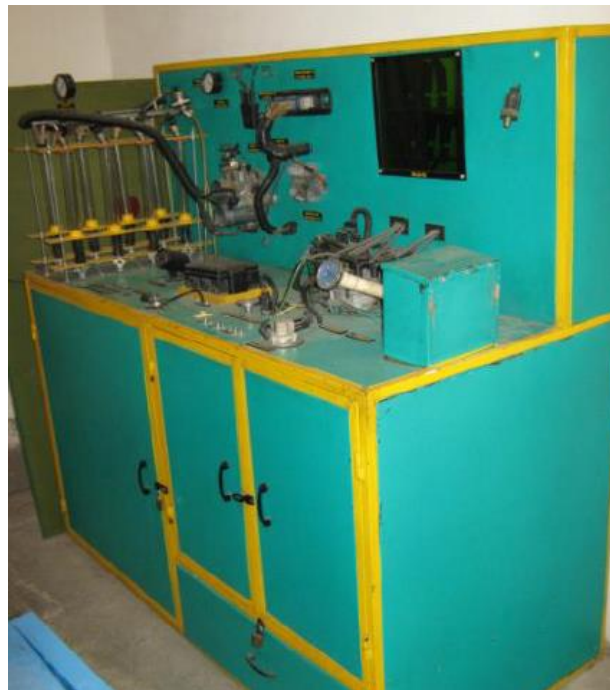
Figura 11. Banco de Inyección antiguo.
