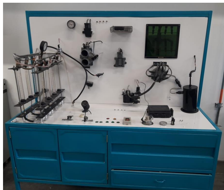
Banco de inyección.
