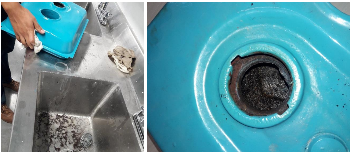
Tanque de gasolina Renault 4. Tanque corroído, presentaba impurezas dentro de él, esto provocó daños en el filtro de gasolina el cual debió ser cambiado.
