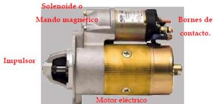
Figura 5. Vista de un sistema de arranque típico.
