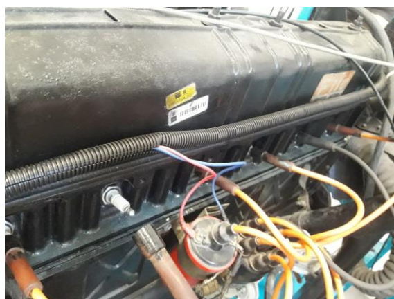
Motor Toyota F110. Presentaba mangueras del sistema de enfriamiento cristalizadas y bujías inservibles.
