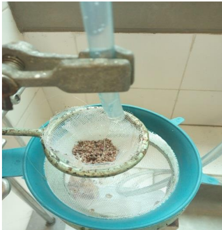
Figura 15. Montaje de lavado de la Bauxita
