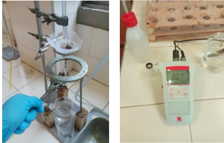
Figura 16. Toma de muestra de pH del agua de lavado
