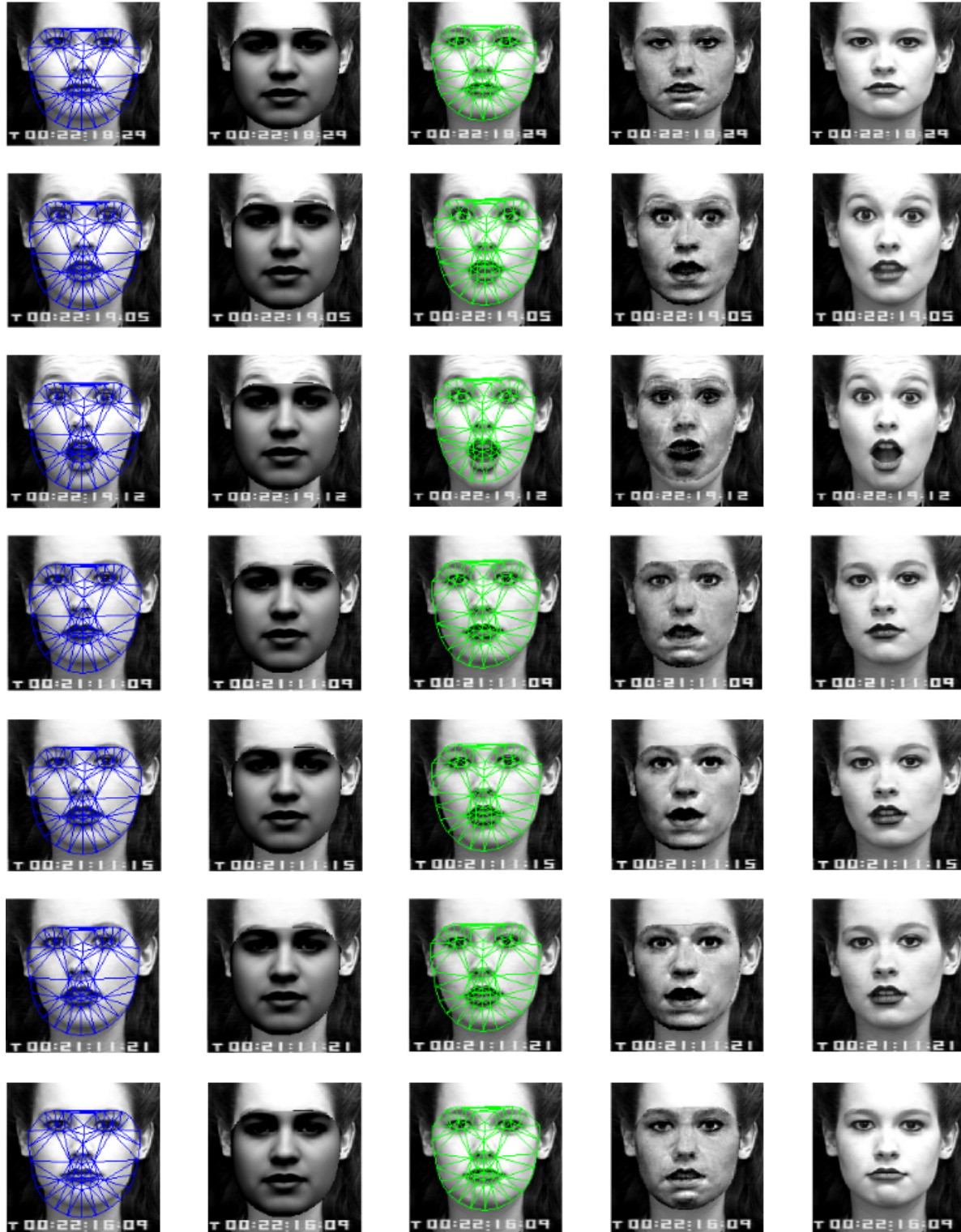
Figura 3.8: Resultados Imágenes 22-28. Para cada renglón, la primera columna muestra el sujeto con la ubicación inicial de la forma media, la segunda columna muestra el mean shape en la posición inicial, la tercera columna muestra el enmallado final después del proceso de minimización sobre la imagen objetivo, la cuarta columna muestra la textura final del modelo sobre la imagen y por último la quinta columna muestra la imagen original. Los datos de error final y número de iteraciones asociadas a estas figuras se encuentran consignados en la tabla 3.1
