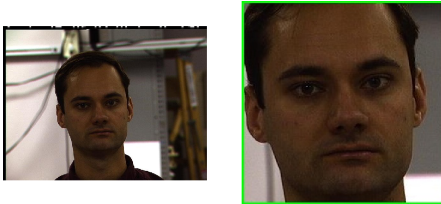
Figura 2.6: Detección de Rostro usando Adaboost sobre una imagen de la base de datos FERET [29] [30]. Algoritmo de Viola y Jones [10]
