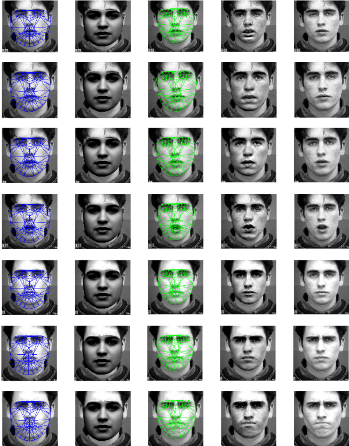
Figura 3.12: Resultados Imágenes 50-56. Para cada renglón, la primera columna muestra el sujeto con la ubicación inicial de la forma media, la segunda columna muestra el mean shape en la posición inicial, la tercera columna muestra el enmallado final después del proceso de minimización sobre la imagen objetivo, la cuarta columna muestra la textura final del modelo sobre la imagen y por último la quinta columna muestra la imagen original. Los datos de error final y número de iteraciones asociadas a estas figuras se encuentran consignados en la tabla 3.1
