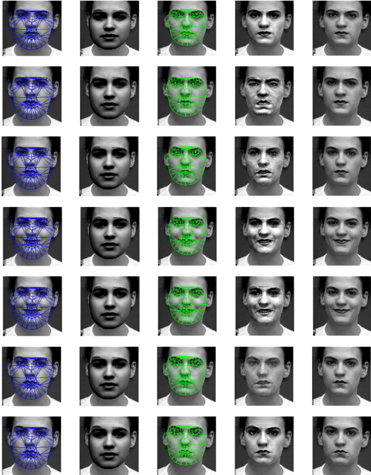
Figura 3.16: Resultados Imágenes 78-84. Para cada renglón, la primera columna muestra el sujeto con la ubicación inicial de la forma media, la segunda columna muestra el mean shape en la posición inicial, la tercera columna muestra el enmallado final después del proceso de minimización sobre la imagen objetivo, la cuarta columna muestra la textura final del modelo sobre la imagen y por último la quinta columna muestra la imagen original. Los datos de error final y número de iteraciones asociadas a estas figuras se encuentran consignados en la tabla 3.1
