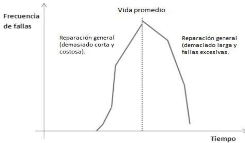
Figura 10. Reparación general basada en el tiempo
