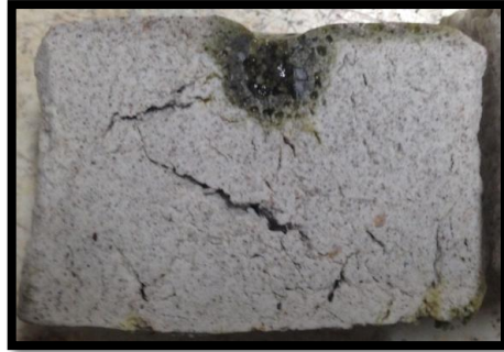
Figura 41. Corte diagonal que muestra el perfil del ataque por escoria.
