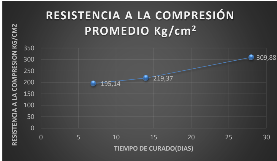
Figura 22. Comportamiento de probetas de CP prueba de resistencia a la compresión (CP=cemento portland).
