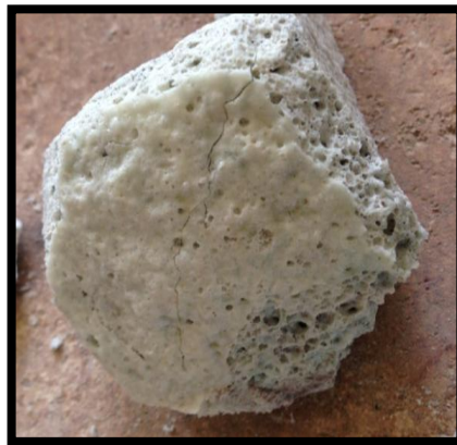
Figura 37. Probeta después de 3 ciclo de enfriamiento aplicando una carga de compresión de 150 kg/cm 2 .
