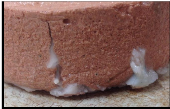
Figura 27. Saturación del espacio poroso de solución ácida ( \text{H}_2\text{SO}_4 ) a los 14 días de inmersión ocasionando agrietamiento del geopolímero.
