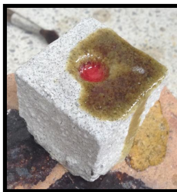
Figura 40. Probeta atacada por escoria después de 2 horas en la mufla.
