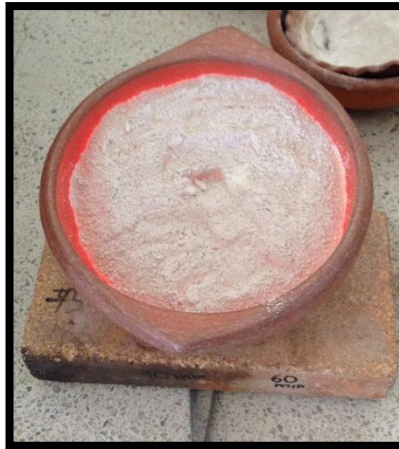
Figura 8. Material final de geopolímero (mezcla sintetizada a 900°C)
