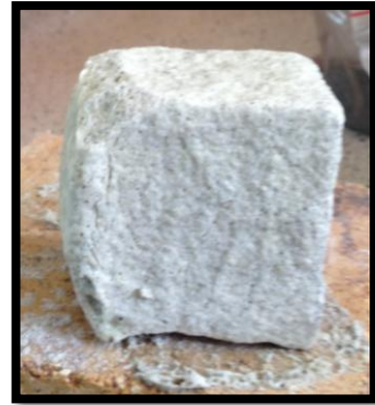
Figura 37. Probeta después de 3 ciclo de enfriamiento aplicando una carga de compresión de 150 kg/cm 2 .
