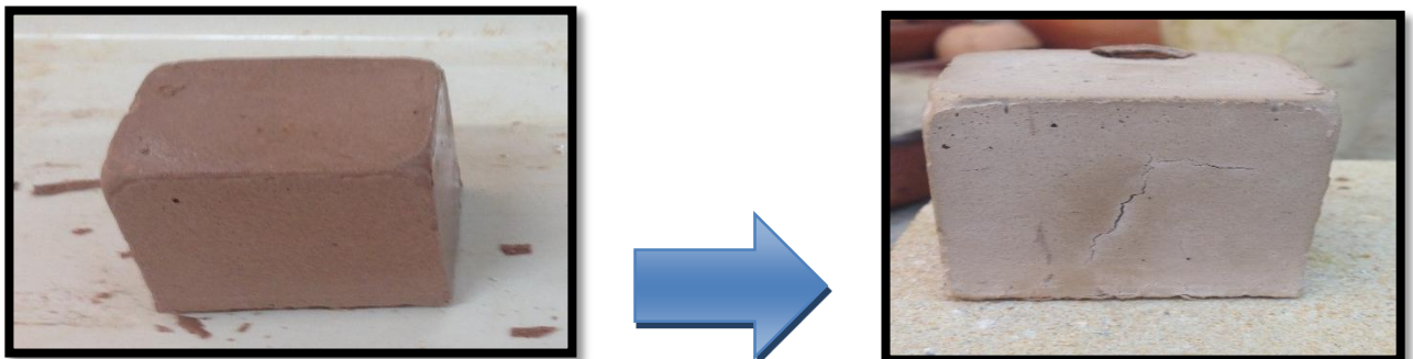
Figura 34. Cambio en la tonalidad y en la forma de los geopolímeros de hidróxido de sodio a temperaturas entre 600-1000°C.
