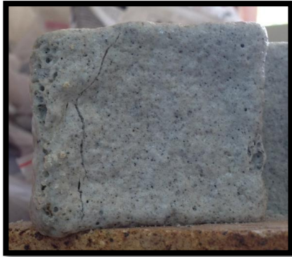
Figura 37. Probeta después de 3 ciclo de enfriamiento aplicando una carga de compresión de 150 kg/cm 2 .
