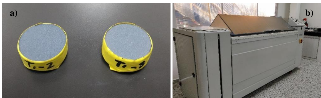
Figura 6. Ensayo de cámara salina: a) Muestras con 0 horas de exposición. b) Cámara Salina Angelantoni DCTC 1200.
