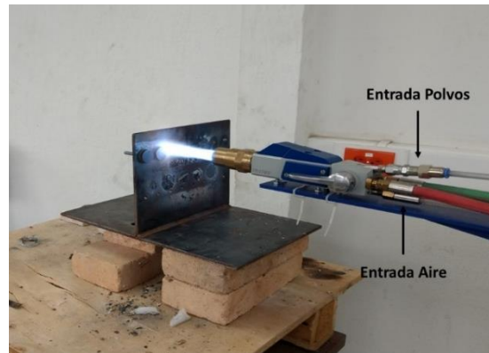
Figura 4. Aplicación de los recubrimientos cerámicos con el equipo de proyección de forma automatizada.
