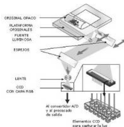
Figura 6. Principio de funcionamiento de un escáner plano
