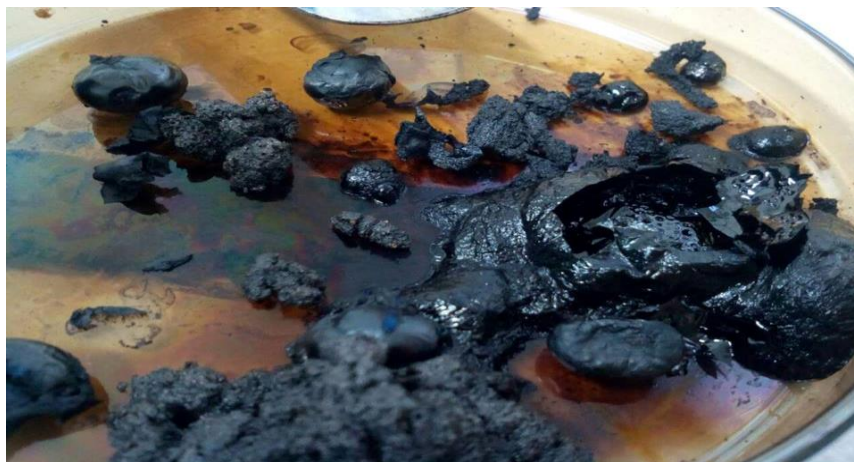
Figura 36. Alquitrán en resultados de torrefacción a 300°C
