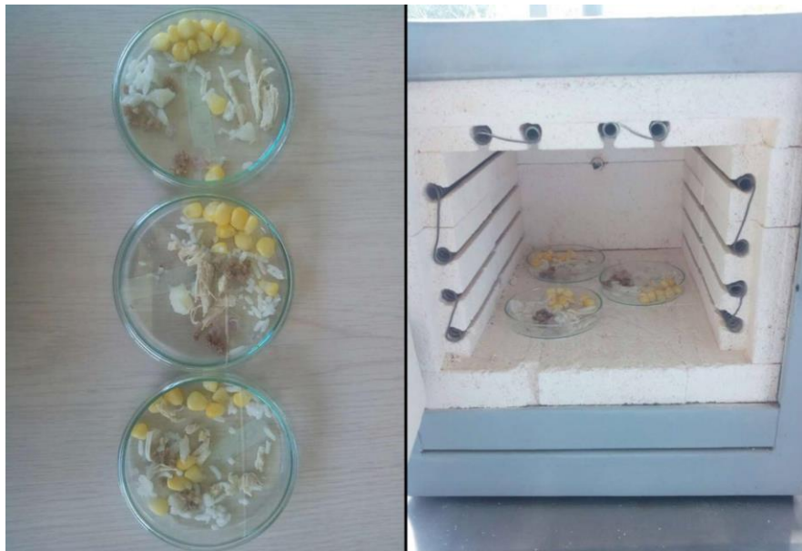
Figura 32. Muestras para torrefacción y su posición en el horno
