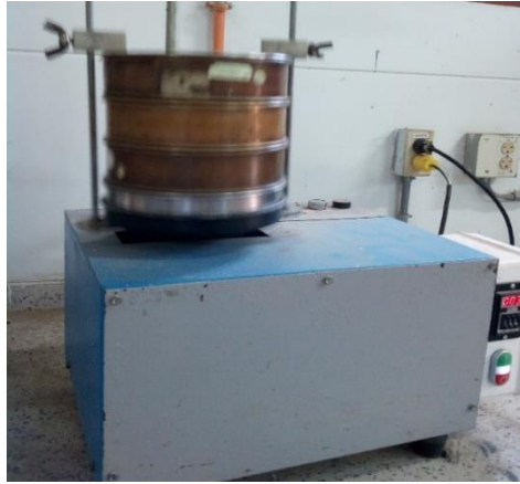
Figura 8. Montaje para realizar el tamizado.
