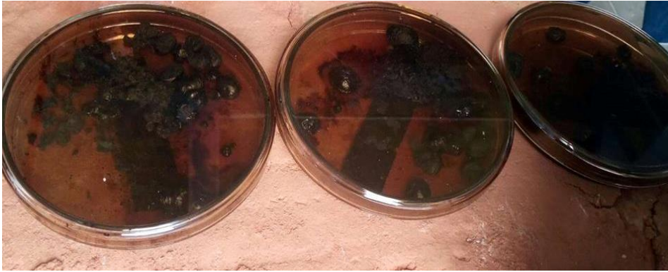
Figura 35. Resultados torrefacción a 300°C
