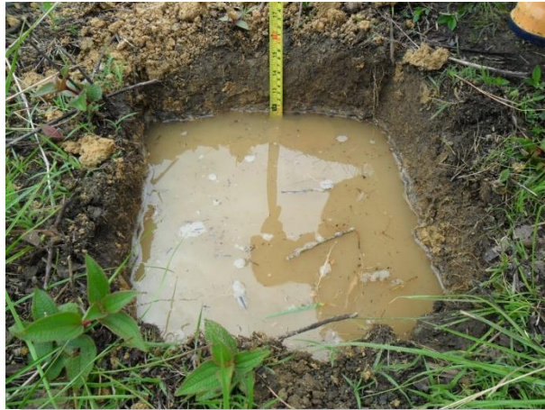
Figura C-1. Prueba de infiltración No. 1 en el terreno.
