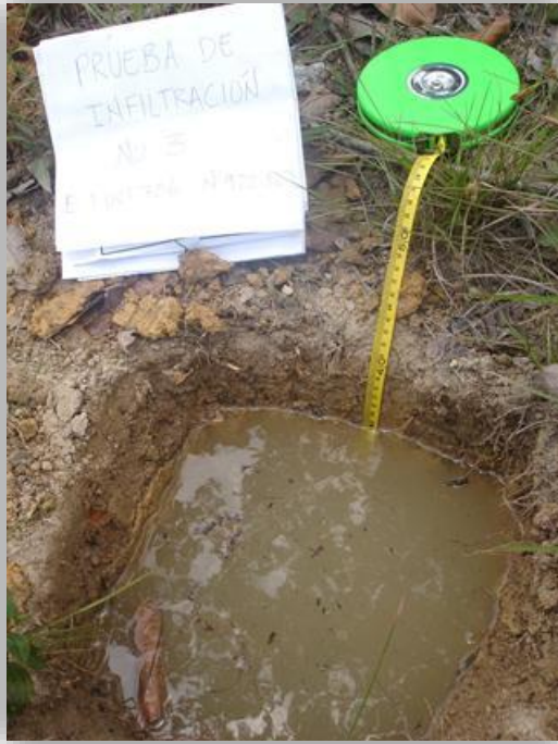
Figura C-3. Prueba de Infiltración No. 3 en predio contiguo a la locación del pozo estratigráfico ANH-BVTURA-1-ST-P.
