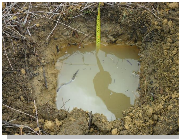
Figura C-2. Prueba de infiltración No. 2 en el terreno.
