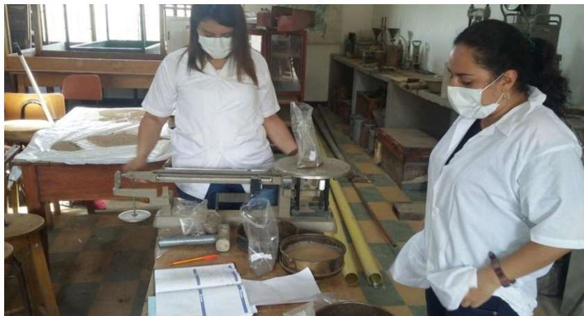
Imagen 13. Toma de datos (peso-gramos) para cada sustrato retenido en los tamices.
