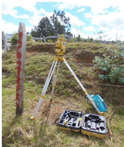
Imagen 7. Nivel Electrónico, marca TOPCON. Ref DL-102C utilizado en el levantamiento.
