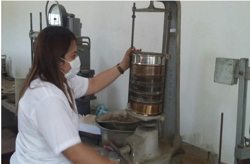
Imagen 12. Proceso de tamizado en el laboratorio de Suelos de la Universidad Industrial de Santander
