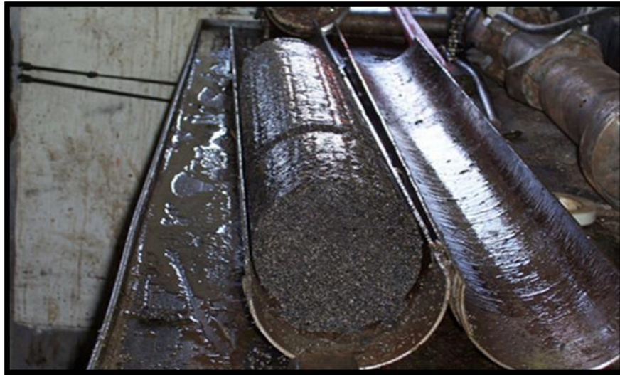
Figura 1: Taponamiento de las líneas de producción por acumulación de granos de arena. Tomado de: http://pennycompendium.com/2011/06/26/china-us-counting-on-albertas-huge-oil-sand-reserves/
