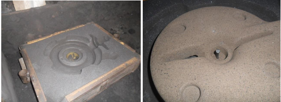
Figura 26. Machos y caja de moldeo cuerpo succión hega 32
