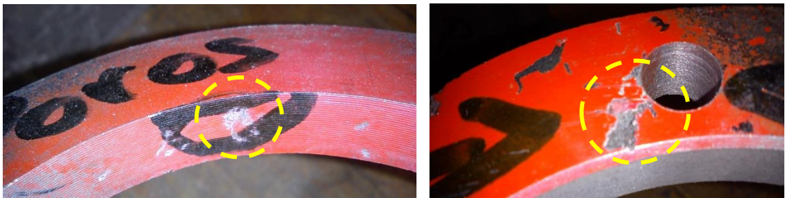
Figura 29. Inclusiones de arena soporte de rodamiento ZInd 25
