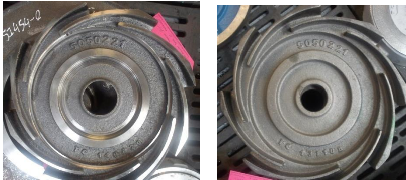
Figura 22. Difusor hega 50 libre de defectos.
