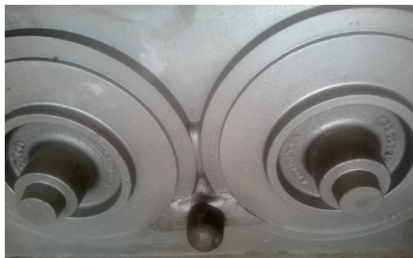
Figura 44. Placa modelo con nuevo sistema de llenado (pocillo) impulsor hega.65
