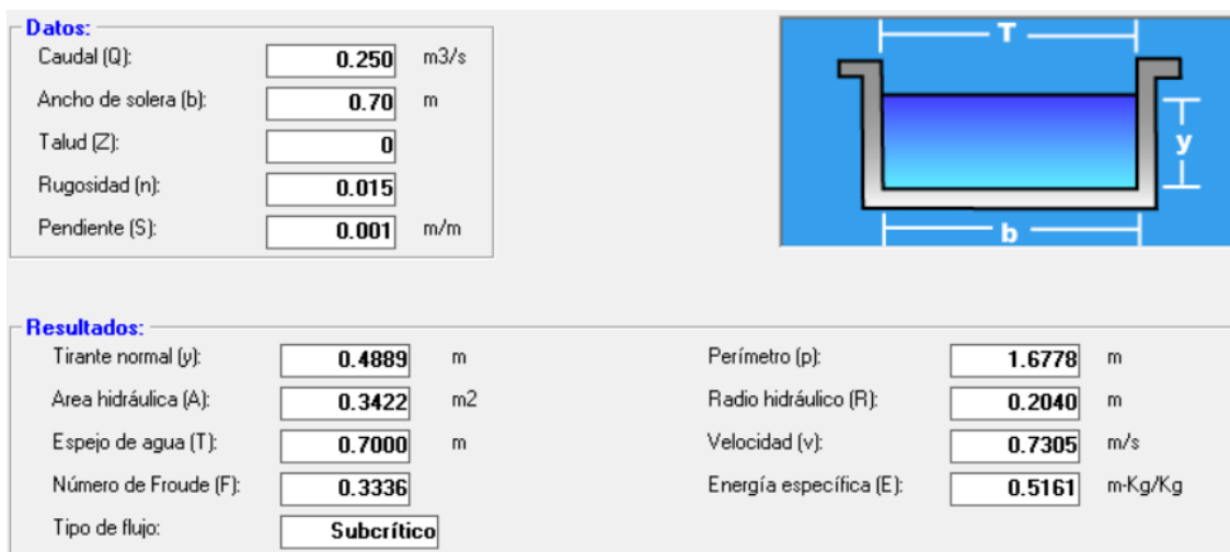
Figura 17 Evaluación Opción estructura rápida escalonada descarga Alcantarilla 2
