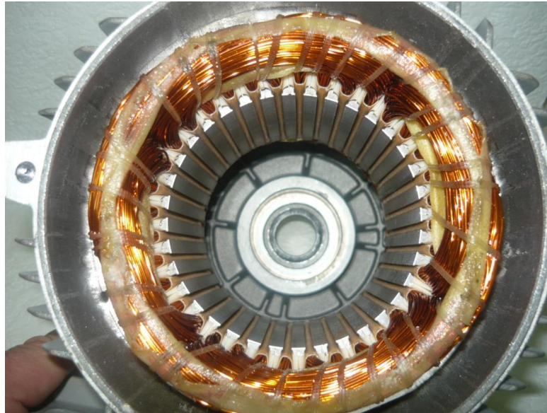
Figura 83. Devanado del estator.
