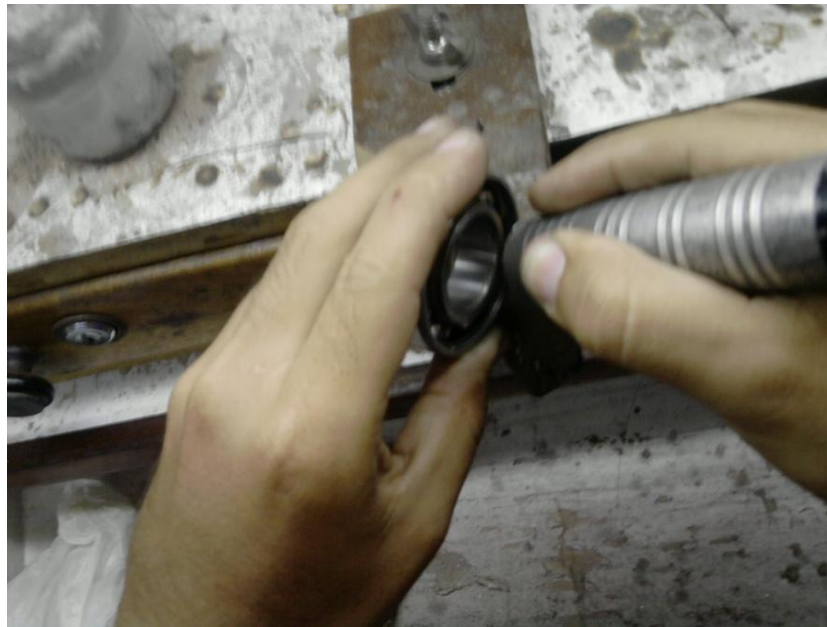
Figura 64. Inducción de la falla del rodamiento
