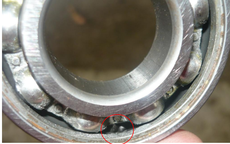
Figura 67. Inducción tres grados de severidad.
