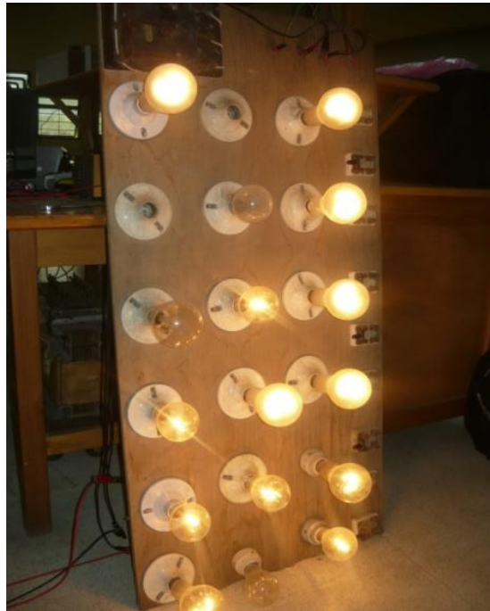
Figura 12. Banco de bombillas para generar la carga de 71.36% y 85.6% en el generador.
