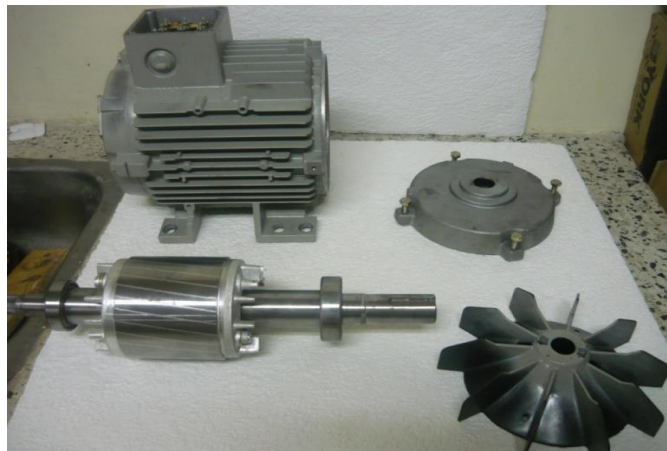
Figura 2. Esquema de máquina asíncrona de rotor jaula de ardilla
