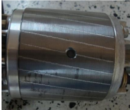
Figura 45. Una barra rota.
