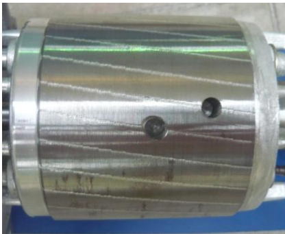
Figura 46. Dos barras rotas.
