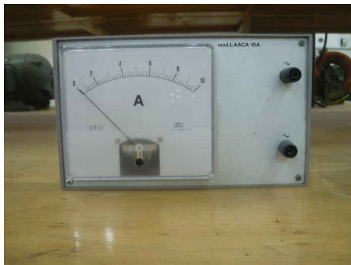
Figura 9. Amperímetro de corriente alterna
