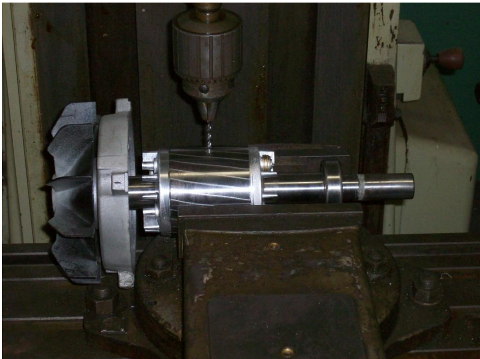
Figura 44. Rompimiento de las barras del rotor.
