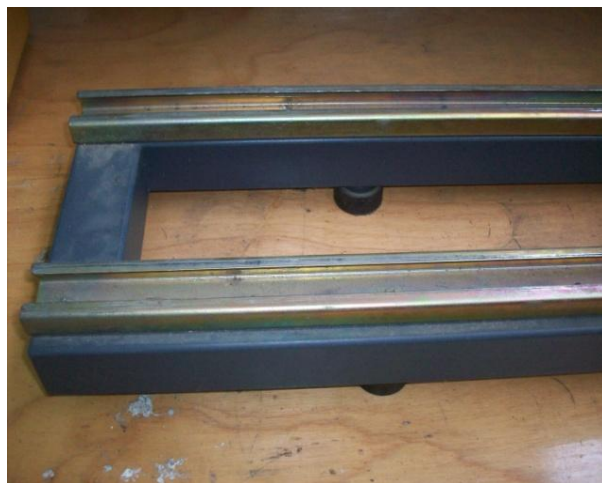
Figura 7. Riel aislador de soporte
