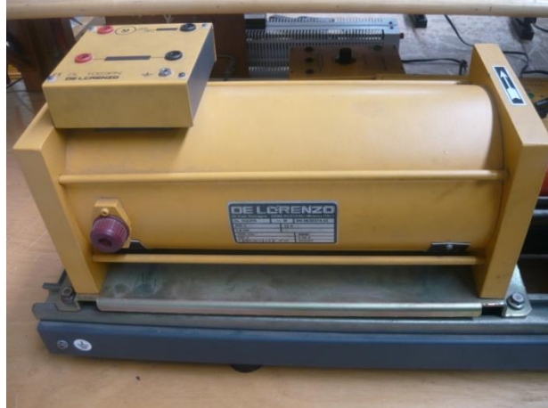
Figura 6. Máquina de DC, usada como generador.
