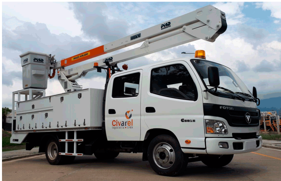
Figura 3. Camión con grúa canasta
