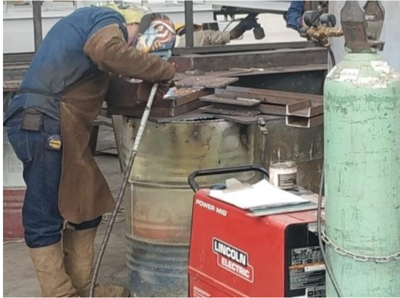
Figura 17. Equipo Lincoln power MIG 256 en operación.
