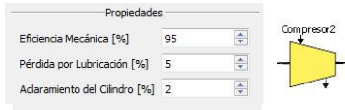
Figura 42. Datos de entrada del compresor.
