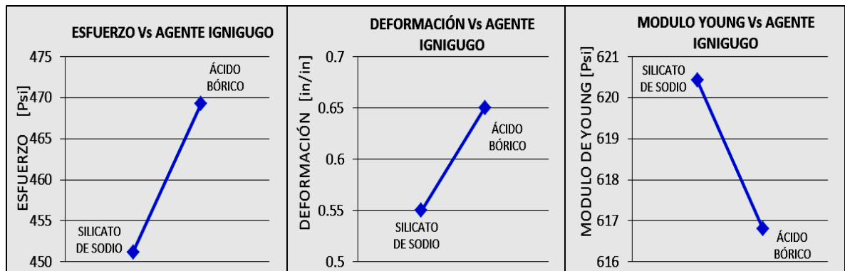
Figura 26. Efecto del agente ignífugo, en análisis prueba de tracción.
