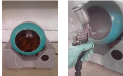
Figura 9. Método de aspersión, para impregnado de fibras de coco enteras.
