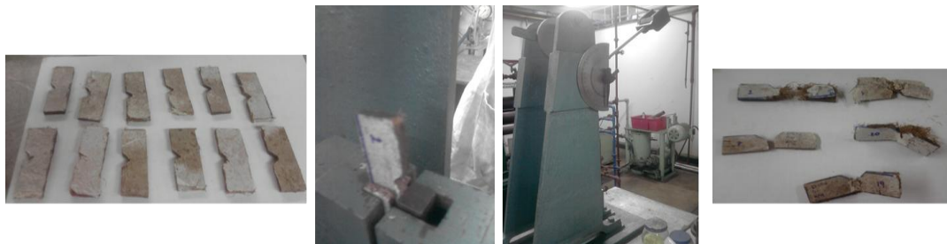
Figura 20. Prueba de impacto tipo Izod.
