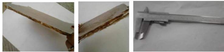
Figura 15. Determinación del espesor de los aglomerados de fibra de coco entera y poliestireno postconsumo.
