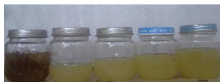
Figura 8. Impregnación de fibras de coco enteras por el método de inmersión.
