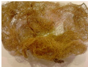
Figura13. Prepregs a base de poliestireno postconsumo y fibras del coco enteras
