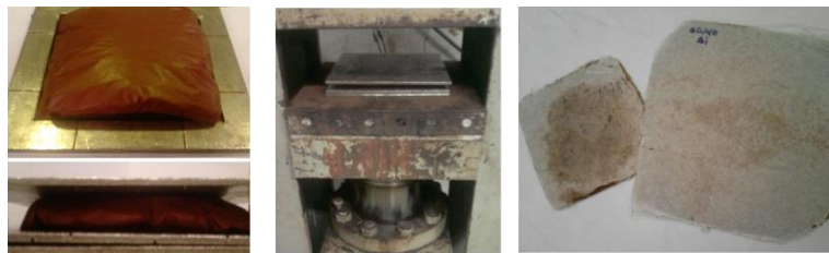
Figura 14. Prensado de prepregs para elaboración de aglomerados a partir de poliestireno postconsumo y fibras de coco enteras.
