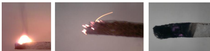
Figura 18. Test de llama de aglomerados de fibra de coco entera y poliestireno postconsumo.
