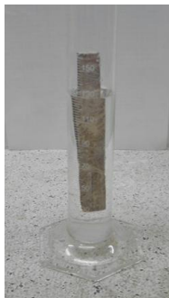
Figura 16. Determinación de la densidad de los aglomerados de fibra de coco entera y poliestireno postconsumo.
