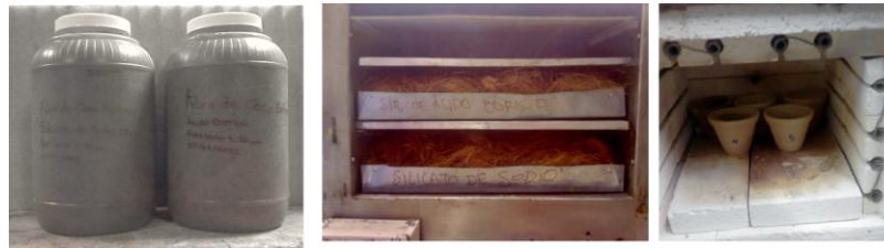
Figura 12. Ignifugado de fibras de coco enteras, determinación de la humedad total y contenido de cenizas.
