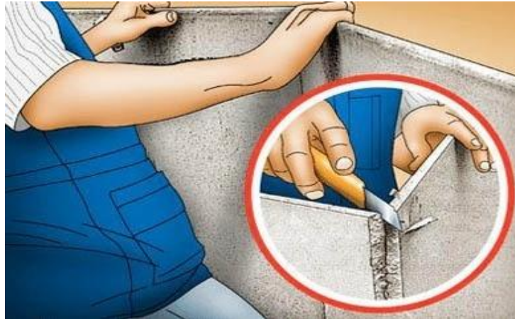
Figura 19. Parar la placa y doblar para cortar
