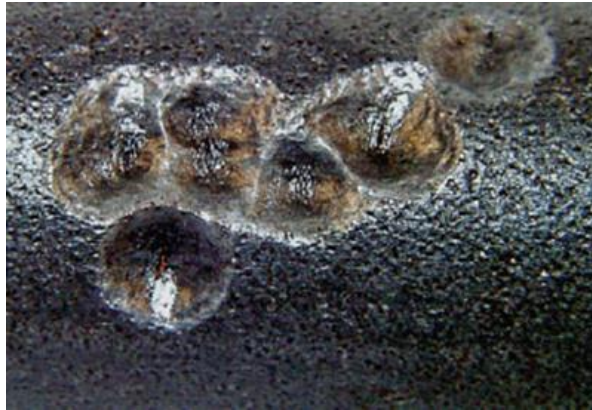
Figura 39. Corrosión por Bacterias SRB
