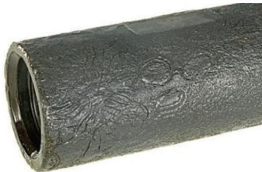
Figura 32. Fallas de Conexión por Impacto
