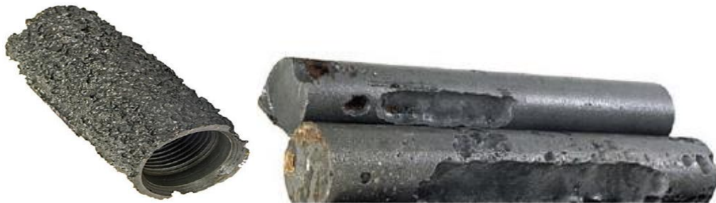
Figura 35. Corrosión por CO 2
