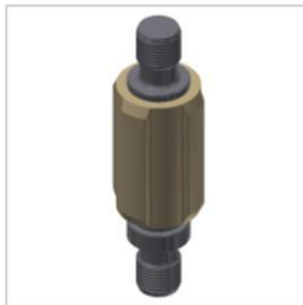
Figura 11. Esquema de un Centralizador
