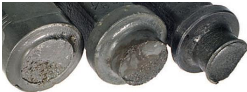
Figura 28. Falla Conexión - Unión Macho
