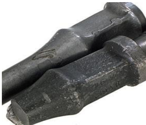
Figura 27. Fallas por daños Superficiales por Elevadores
