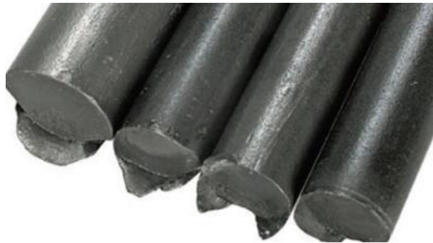
Figura 26. Fallas por daños Superficiales por Herramientas
