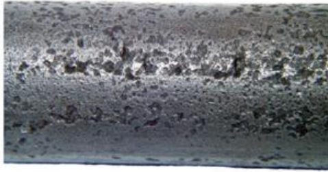
Figura 34. Corrosión por Cloruros
