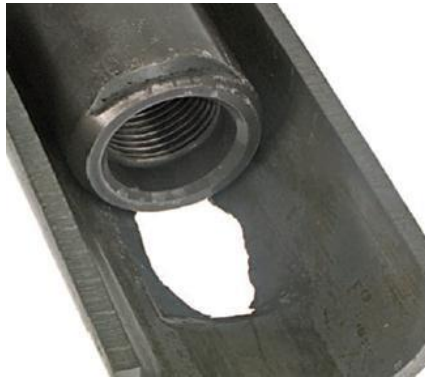
Figura 22. Fallas de diseño y operación – Acople contra tubo
