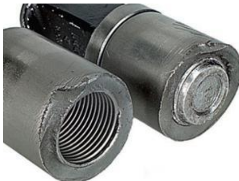
Figura 29. Falla Conexión – Acople
