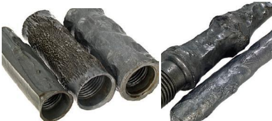
Figura 40. Corrosión Intensificada por O 2
