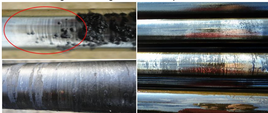
Figura 49. Desgaste de Varilla por Fricción
