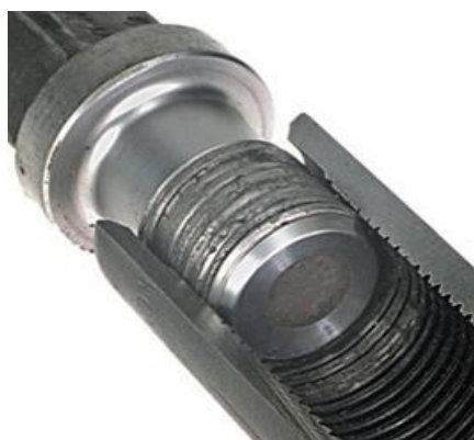
Figura 30. Falla Conexión - Rosca
