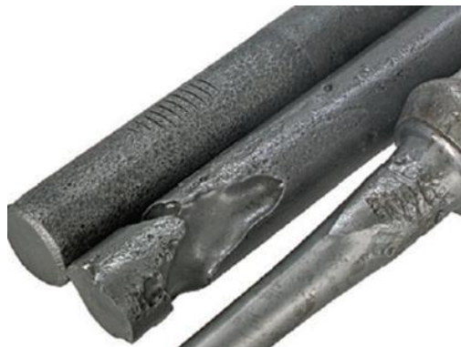
Figura 23. Fallas de diseño y operación – Guía de varilla
