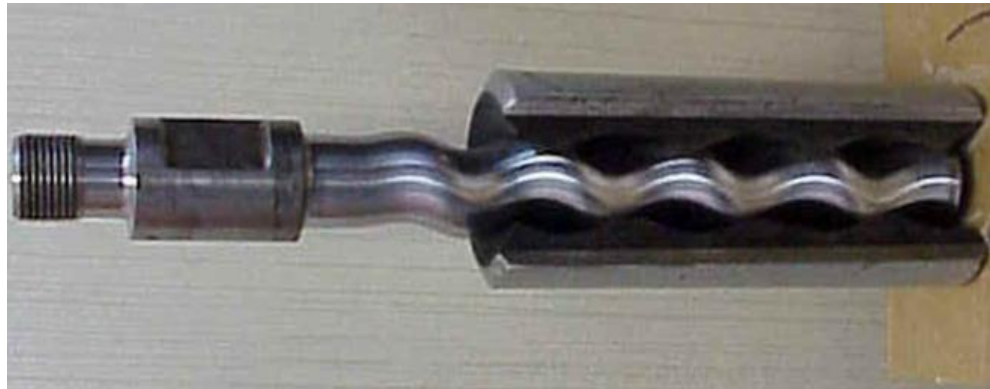
Figura 10. Vista transversal de un Rotor
