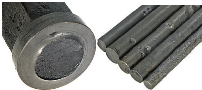
Figura 36. Corrosión por H 2 S
