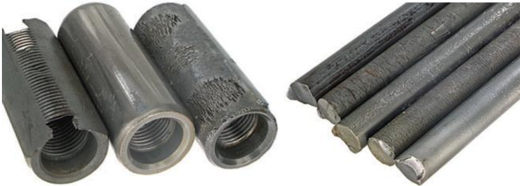
Figura 21. Fallas de diseño y operación – Coupling y Varilla
