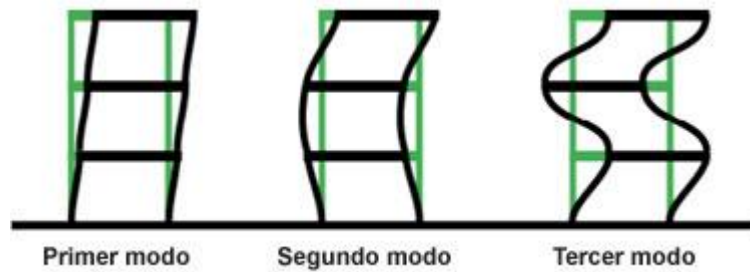
Figura 1. Modos de Vibración de un sistema de 2 GDL.
