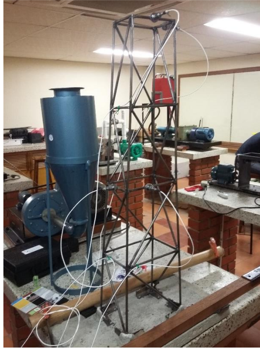
Figura 15. Montaje de los acelerómetros para los ensayos experimentales
