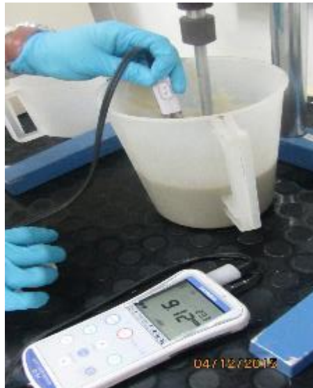
Figura 2. Preparación del lodo de perforación para el experimento. Verificación y mantenimiento del PH y las propiedades del lodo.
