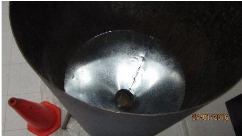
Figura 36. Cono para dirigir la ruta de los cavings hacia el tubo.
