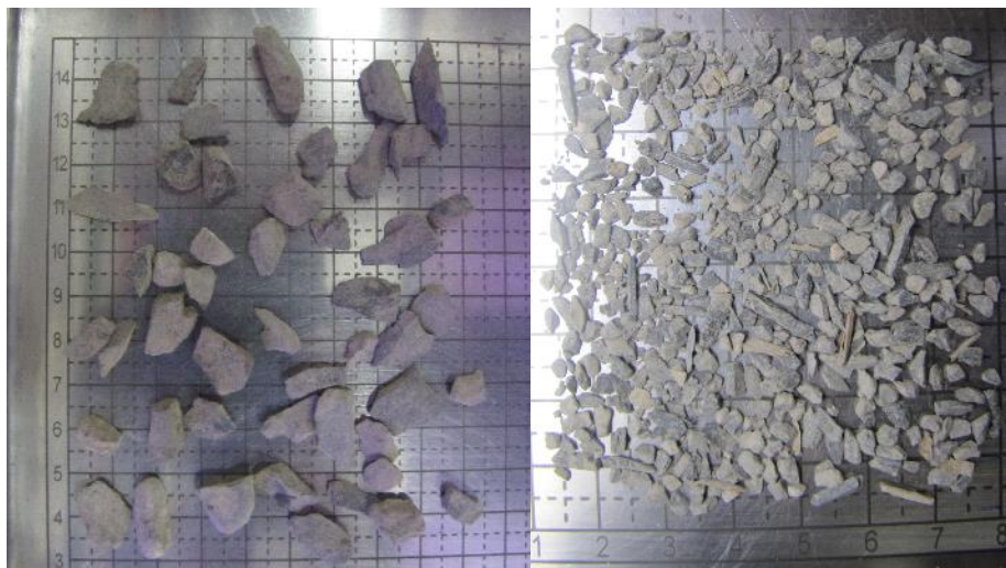
Figura 39. Izquierda: Cavings grandes (10-20mm). Derecha: Cavings pequeños (1-10mm)
