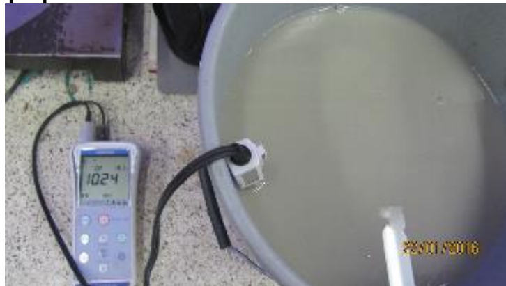
Figura 17. Equipo para la medición del PH del lodo.
