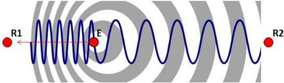
Figura 10. Representación del efecto doppler; una fuente en movimiento y dos observadores.
