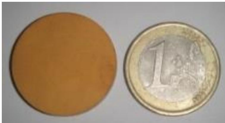
Figura 3. Cristal piezoeléctrico P tipo moneda.
