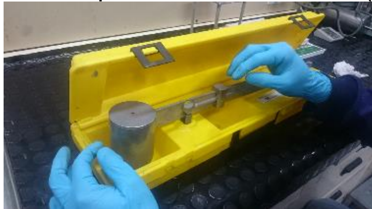
Figura 16. Balanza de lodo para calcular la densidad del lodo (lb/gal).
