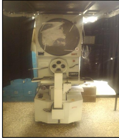
Ilustración 17 Proyector de perfiles para longitudes y grados
