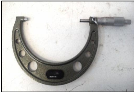
Ilustración 14 Micrómetro análogo de exteriores 100-125 mm
