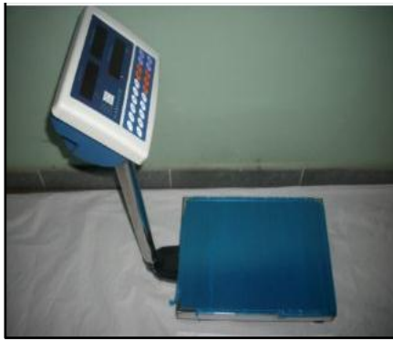
Ilustración 7 Balanza digital de plataforma 10–100 Kg
