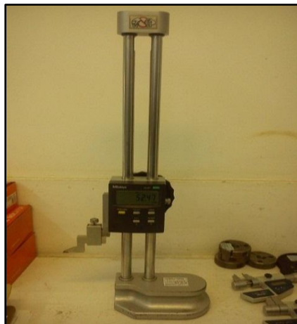
Ilustración 12 Calibrador de alturas digital 0-450 mm
