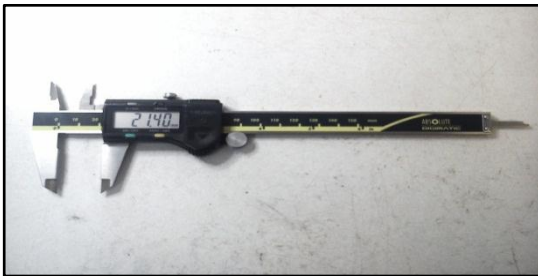
Ilustración 10 Calibrador Pie de rey digital 0-150 mm
