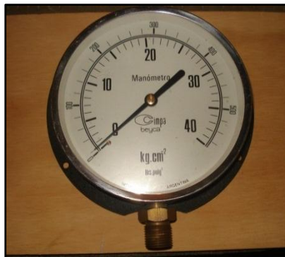
Ilustración 8 Manómetro de carátula 0-600 PSI
