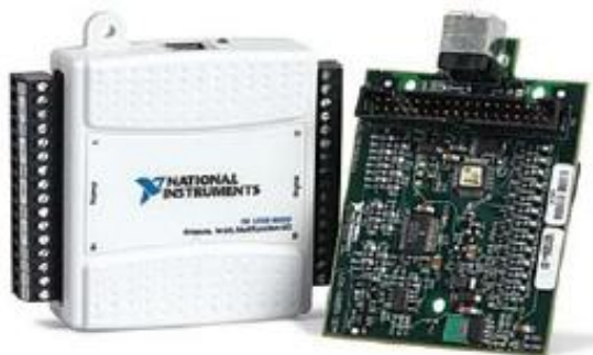
Figura 23. Tarjeta de adquisición de datos DAQ-6009 Fuente: User guide and specifications USB 6008-6009, National Instruments.
