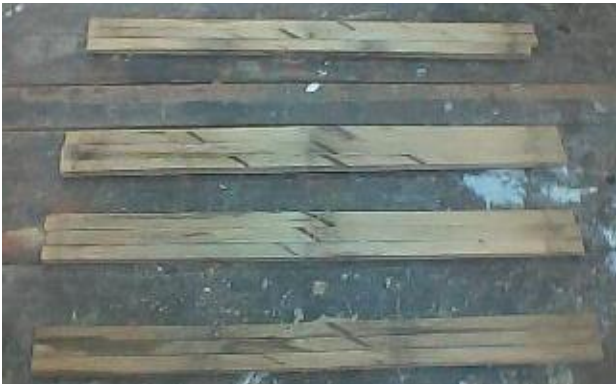
Figura 21. Latas encoladas por los cantos
