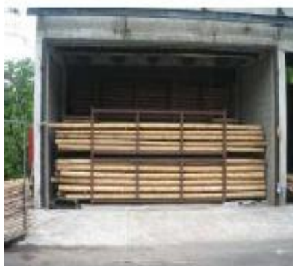
Figura 7. Curado en cámara
