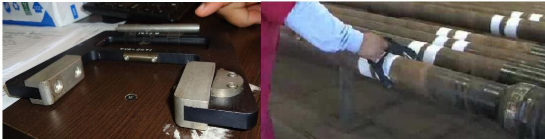
Imagen 55. Calibración de OD
