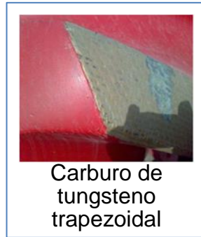
Imagen 13. Tipos de endurecido superficial
