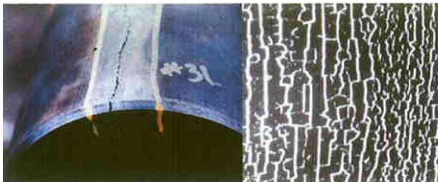
Imagen 28. Falla split box (izquierda) asociada con “heat checks” (mostradas bajo luz ultravioleta a la derecha)
