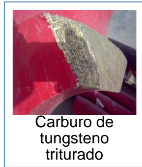
Imagen 13. Tipos de endurecido superficial
