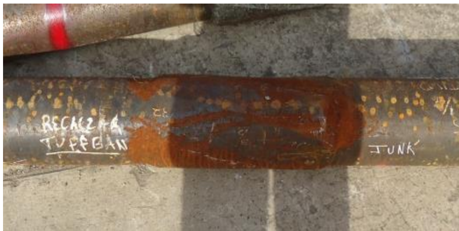
Imagen 68. Desgaste severo de las cuchillas
