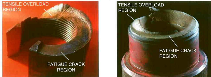
Imagen 27. Falla por fatiga típica: Box de Drill Collar de 8" (Izquierda), conexión Pin (Derecha)
