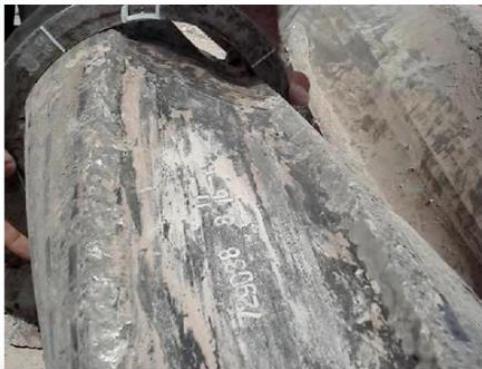
Imagen 60. Calibración del OD del estabilizador
