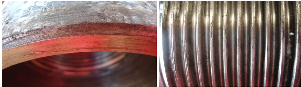
Imagen 32. Melladuras en el sello y roscas
