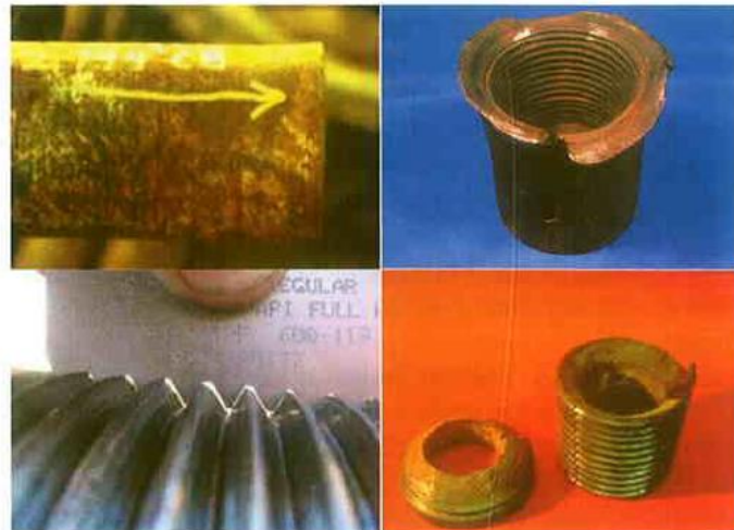
Imagen 29. Falla por torsión en el Box y Pin
