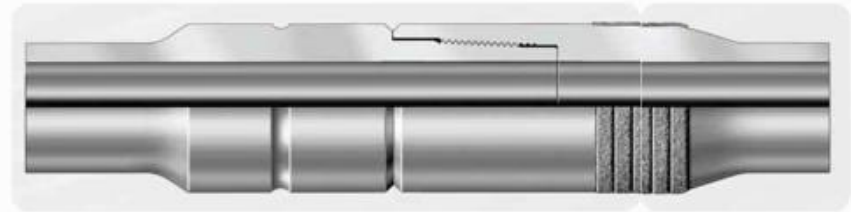
Imagen 21. Perfil de la conexión Grant Prideco High Torque®
