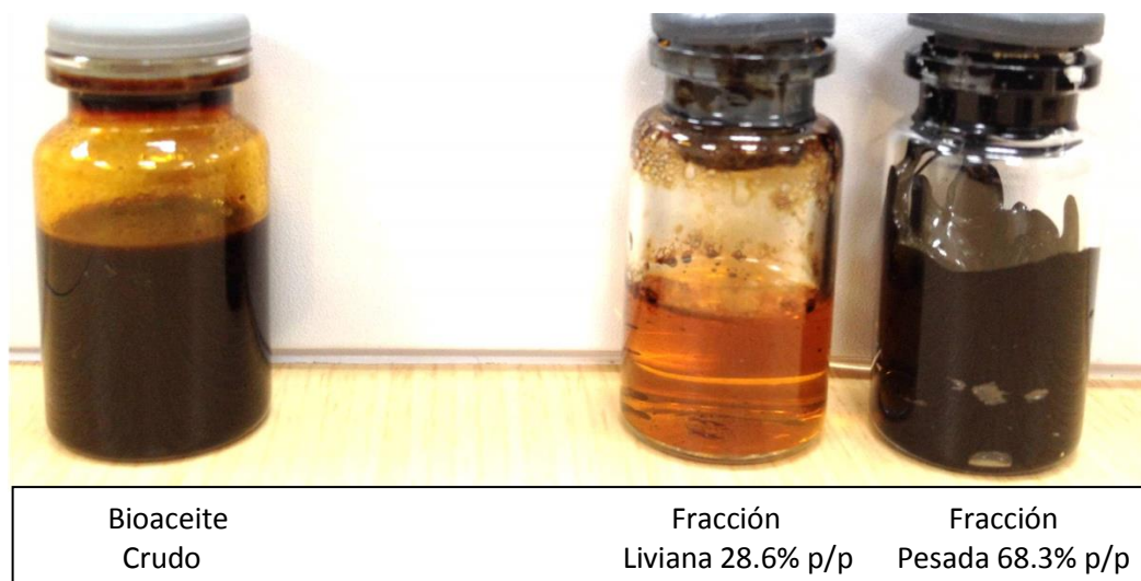
Figura 5. Aspecto Aceite de Pirólisis Crudo y sus Productos de Hidrotratamiento a 180°C para el catalizador NiMo/Al 2 O 3 .
