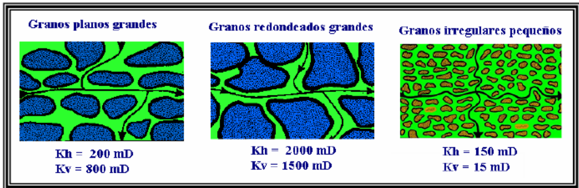
Figura 56. Influencia de la forma y el tamaño de los granos sobre la permeabilidad.
