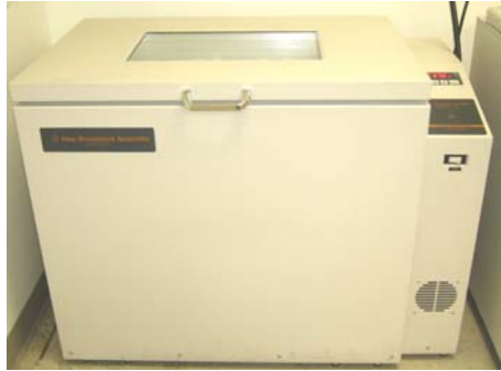
Figura 12. Incubadora 37°C, para cultivo anaeróbico 37°C, 250 rpm
