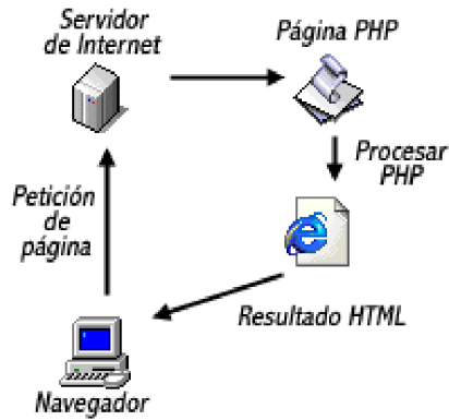
Figura 1. Esquema general de funcionamiento de PHP
