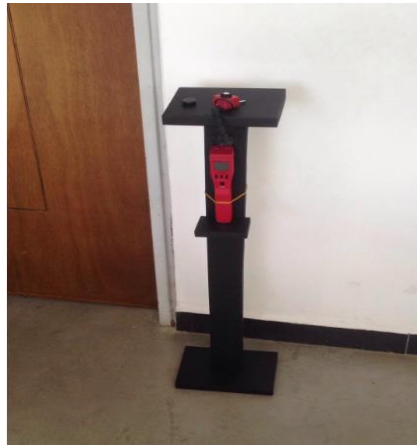
Figura 32. Luxómetro a la altura del nivel de trabajo de 0,75 m.
