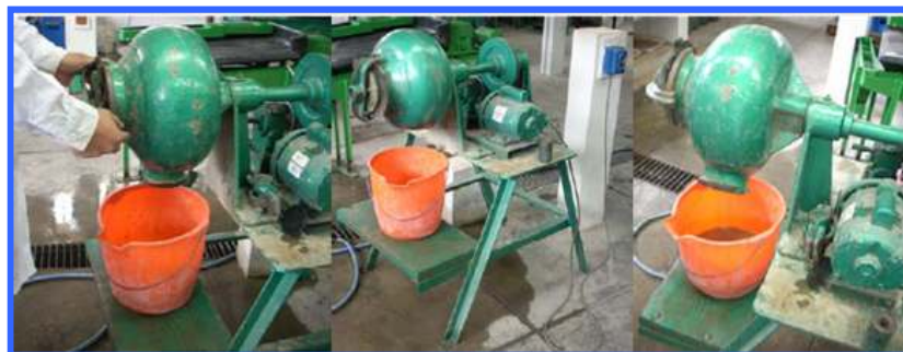
Figura No. 27. Molienda del mineral (Mina la Elsy Ltda.)
