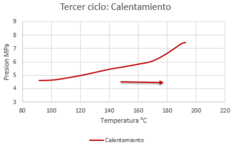
Figura 14. Tercer ciclo del tratamiento de flexión
