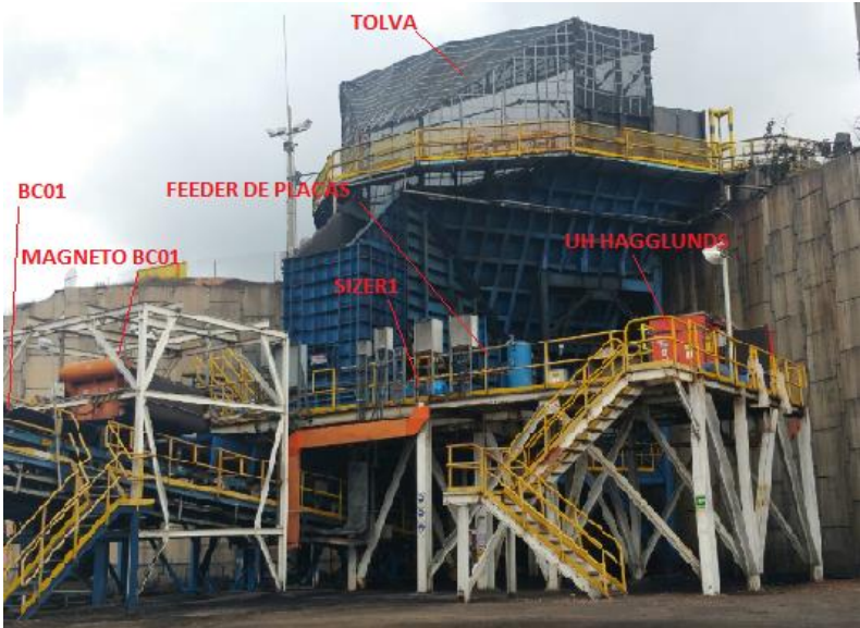
Figura 22. Distribución de equipos del sistema de trituración
