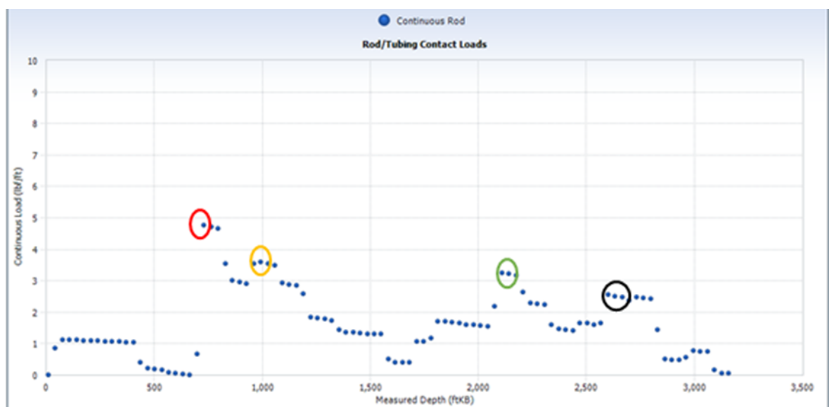
Figura 30. Gráfica cargas de contacto entre tubería y varilla pozo CBE-X.
