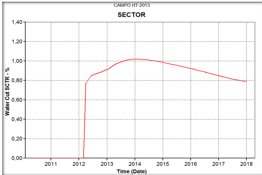
Figura 39. Corte de agua de los pozos productores, en la recuperación primaria para el sector
