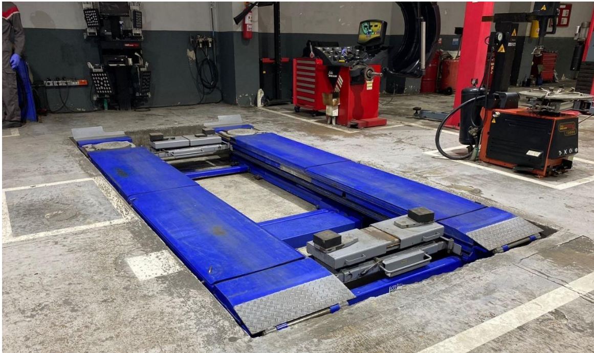
Elevador hidráulico tipo tijera
