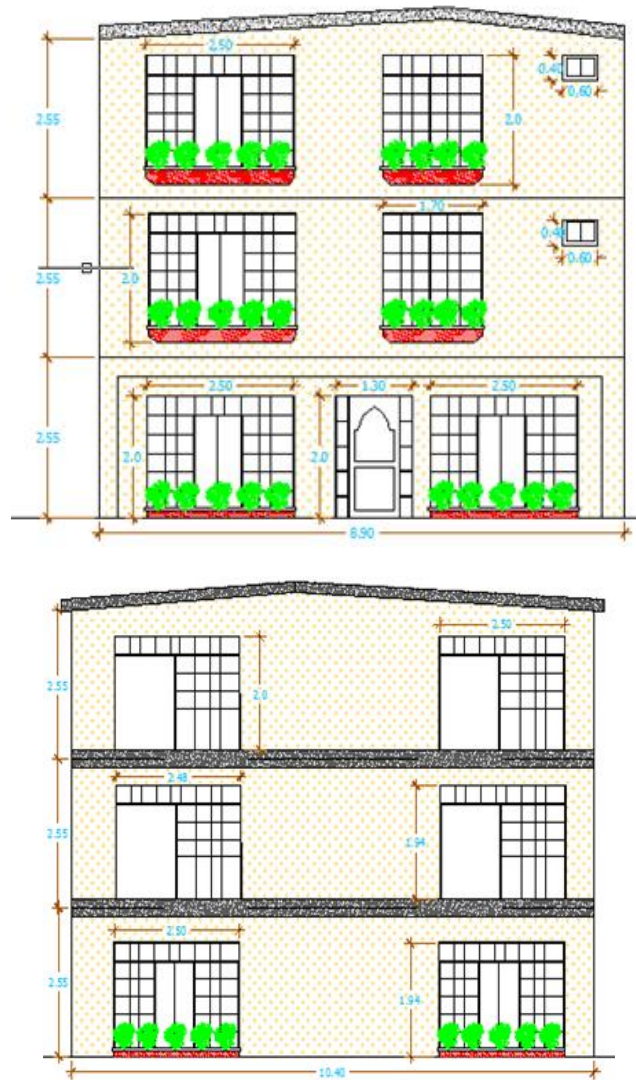
Figura 6. Fachada y vista lateral de la vivienda Tipo II (Dimensiones en metros).
