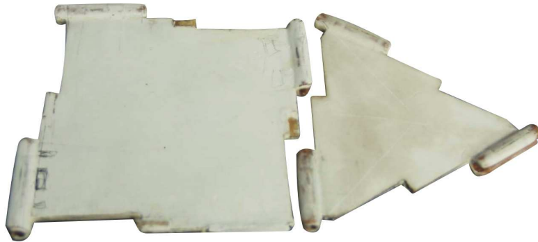
Figura 117. Pre-modelo para construcción del molde
