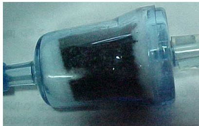
Figura 22. Filtro de Carbón Activado
