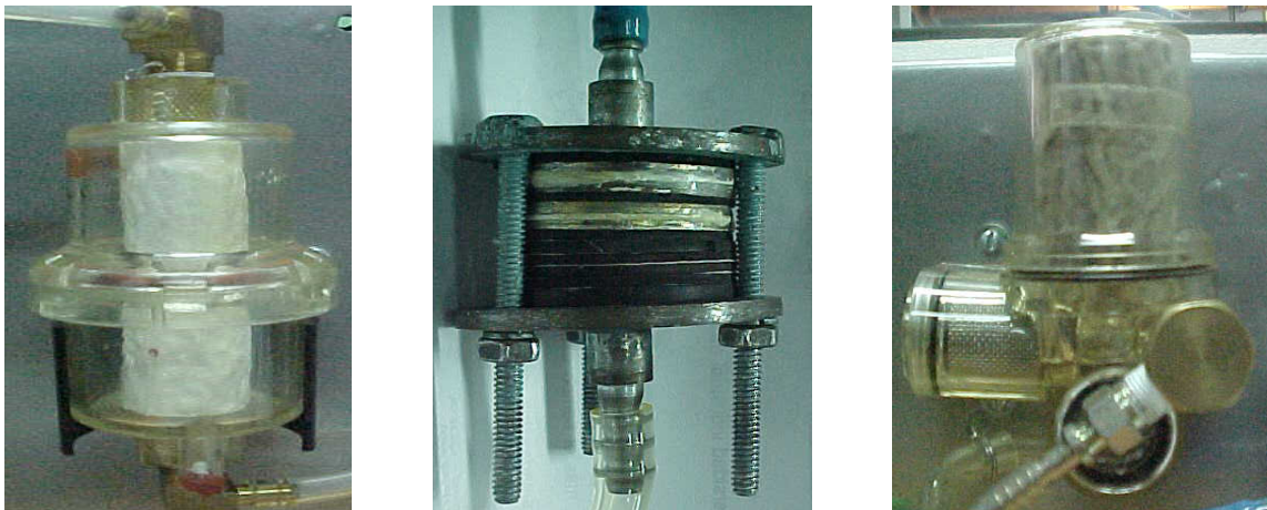
Figura 17. Filtros de Material particulado: Filtro Primario-Secundario, Trampa de Filtros y Vaso Trifilter
