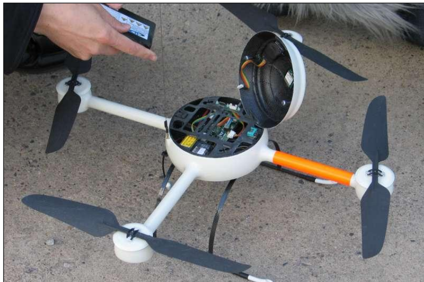
Figura 6. Estructura de Quadrotor tipo cerrada
