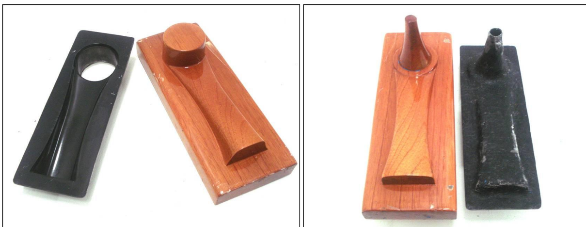
Figura 127. Moldes en madera y contra-moldes en fibra de vidrio
