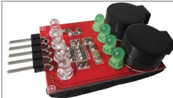
Figura 83. Alarma sonora de baja tensión para baterías LiPo de 3-4S.
