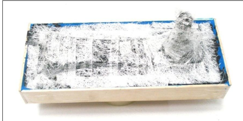
Figura 125. Cubrimiento de fibra de vidrio sobre la capa de Gel Coat
