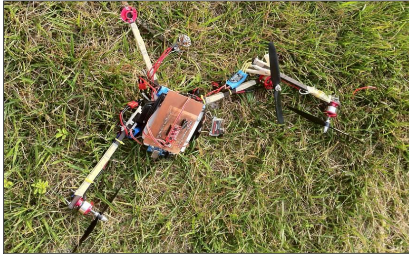
Figura 4. Daños en la estructura de un Quadrotor
