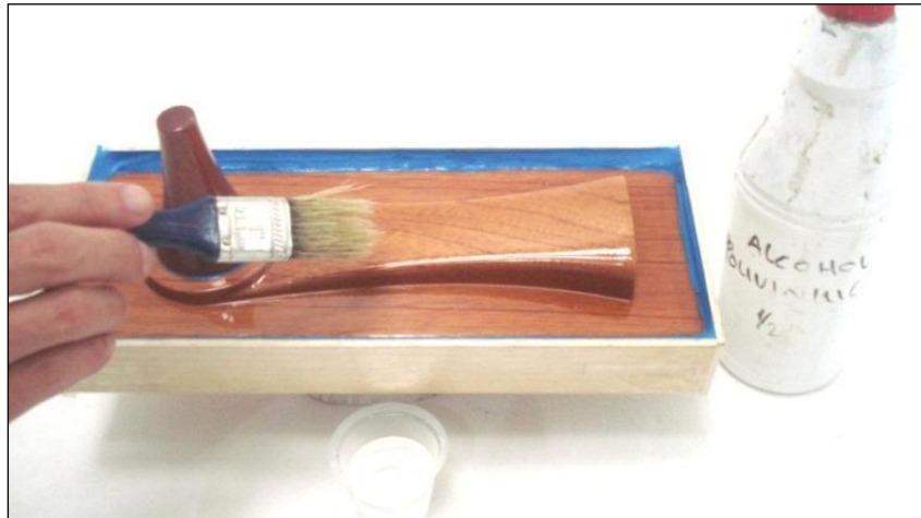
Figura 123. Aplicación del alcohol polivinílico.
