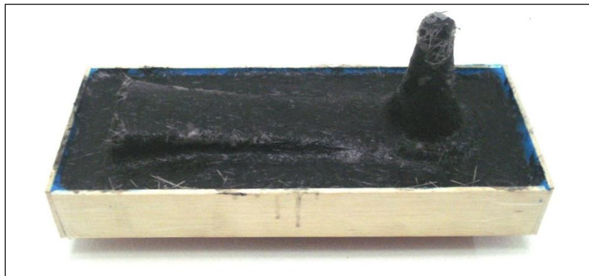
Figura 126. Impregnación de la fibra de vidrio con resina poliéster
