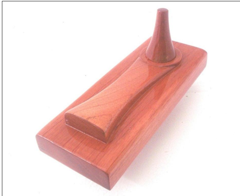
Figura 121. Superficie del molde lijada y tratada con laca de poliuretano.
