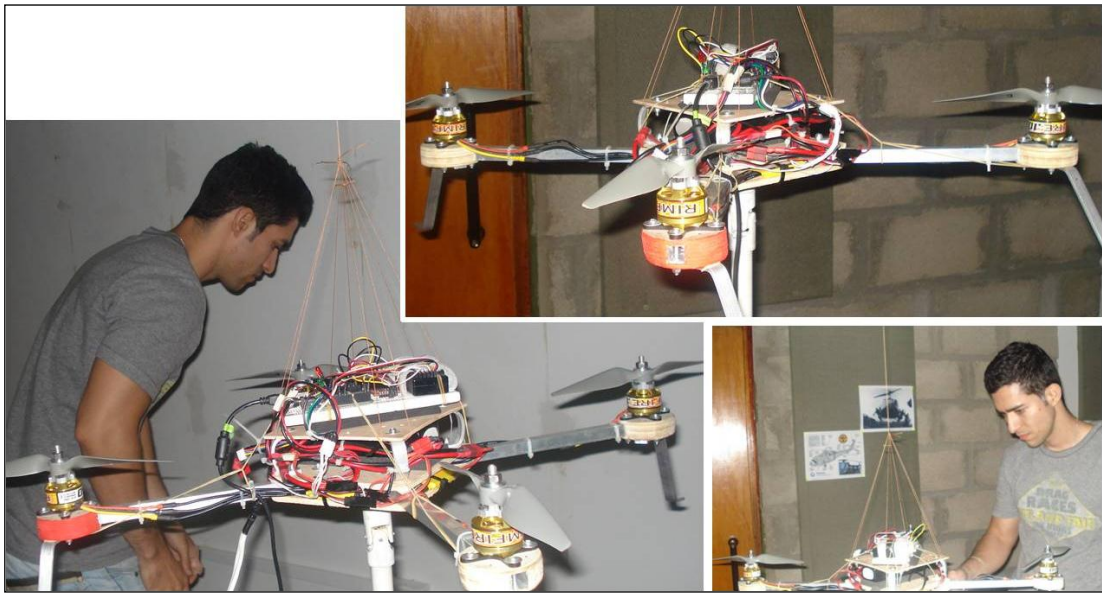
Figura 159. Pruebas de integración de los equipos.
