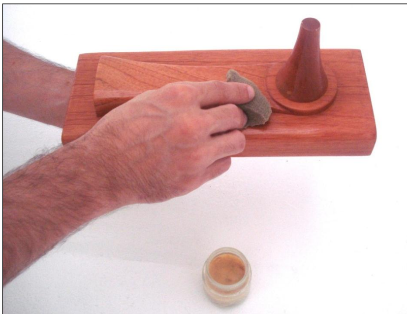
Figura 122. Aplicación de cera desmoldante en la superficie del molde.
