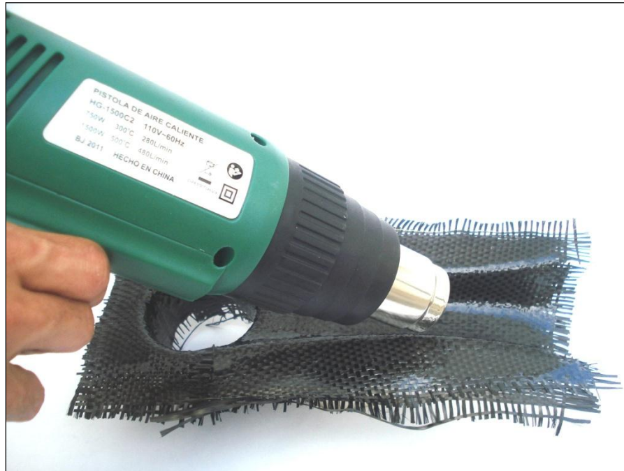
Figura 133. Empleo de pistola de aire caliente sobre la fibra de carbono.
