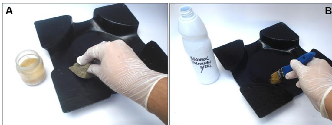
Figura 129. Aplicación de agentes desmoldantes en el contra-molde.
