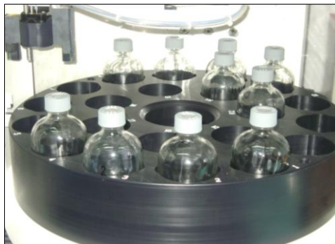
Figura 8. Celdas y bandeja de recolección con 24 botellas del Equipo Extracción Acelerada ASE 350.
