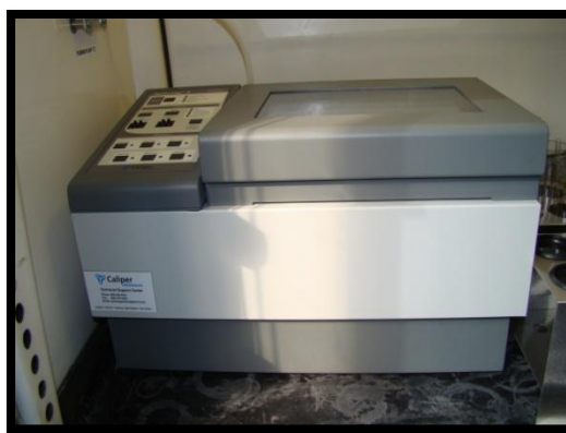
Figura 9. Equipo Turbo Vap , utilizado en la evaporación de los solventes
