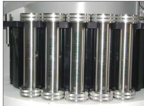
Figura 8. Celdas y bandeja de recolección con 24 botellas del Equipo Extracción Acelerada ASE 350.
