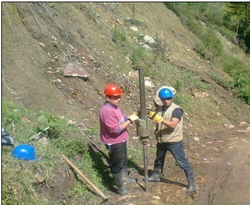
Figura 39. Ensayo de penetración estándar
