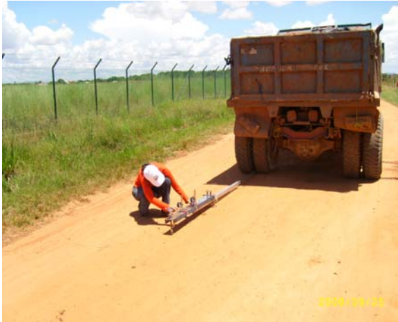
Figura 1. Ensayo de Viga Benkelman
