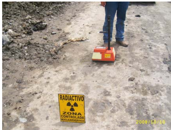
Figura 21. Densímetro nuclear con aviso de seguridad
