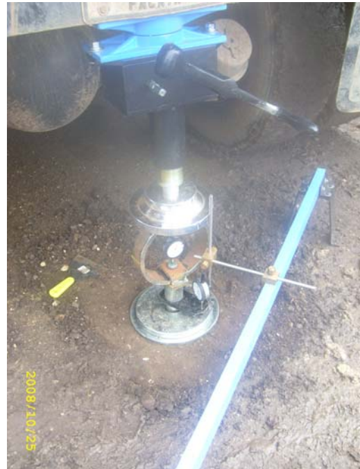
Figura 26. Montaje con Gato, anillo de carga y diales de deformación.
