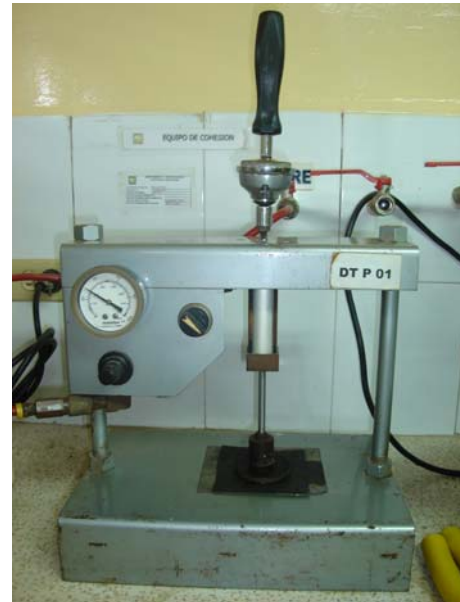
Figura 31. Cohesímetro preparado para el torque.
