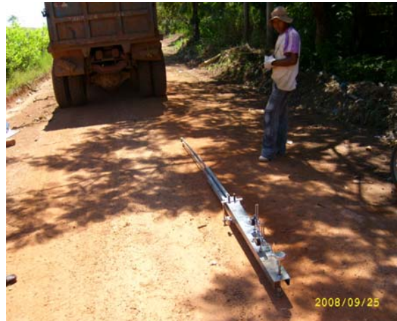
Figura 2. Viga Benkelman al quitar carga
