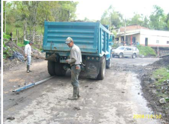
Figura 20. Ensayo viga Benkelman
