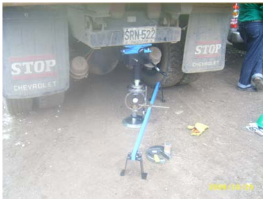
Figura 23. Montaje del aparato CBR
