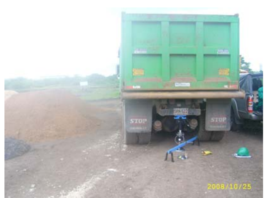
Figura 24. Montaje completo de CBR
