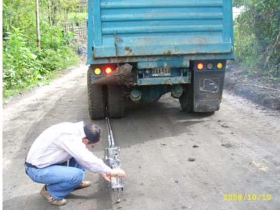
Figura 19. Ensayo viga Benkelman Colocando los deformímetros en Cero.
