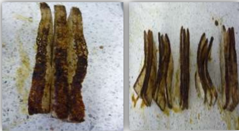
Figura 13. Estado final del material luego de aplicar el método de co-inmovilización en vinazas. Se evidencia para los diferentes grosores.
