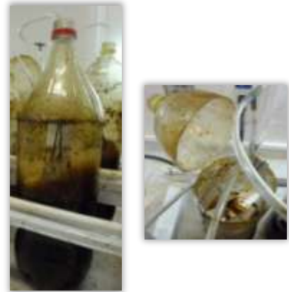
Figura 4b. Montaje Fotobiorreactor con vinazas.
