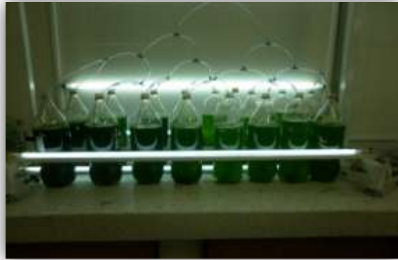
Figura 3b. Montaje completo de fotobiorreactores. Se aprecia el sistema de aireación.
