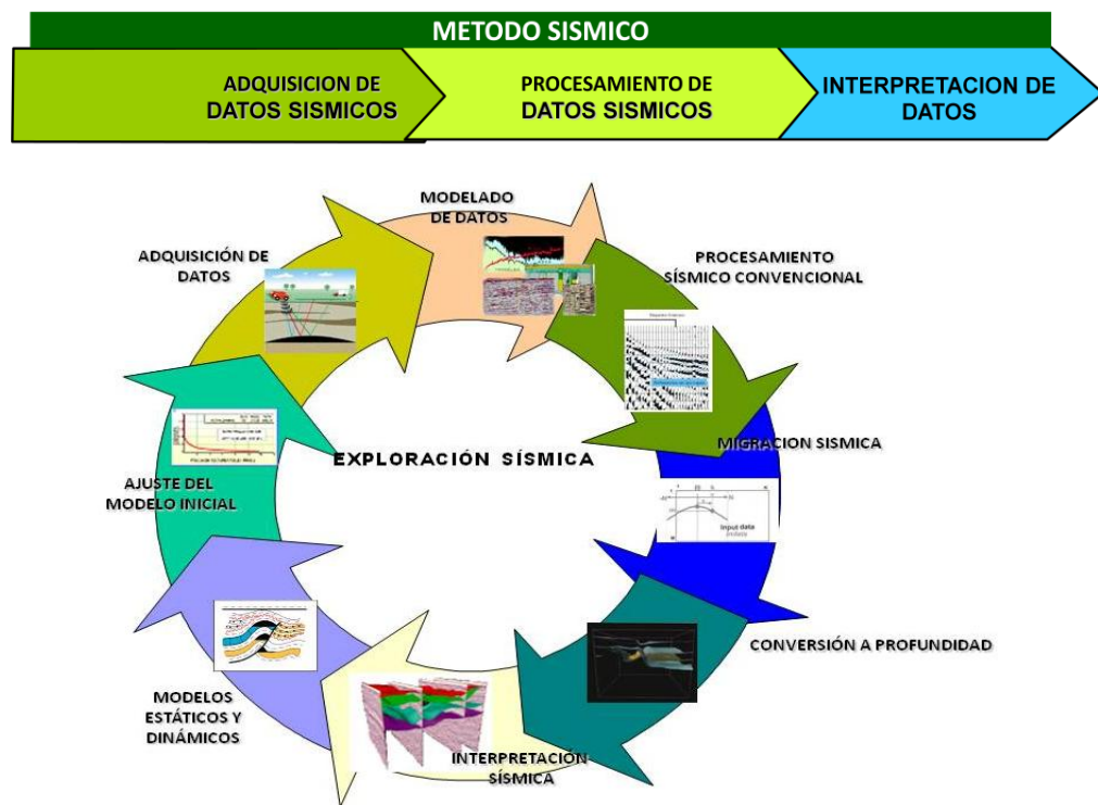
Figura 3. Representación de los pasos básicos del método sísmico. Adquisición, Procesamiento e Interpretación.
