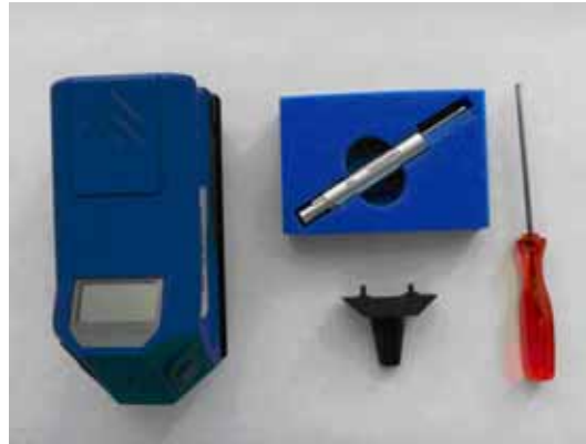
Figura 3.6 Equipo para análisis de rugosidad (rugosímetro)
