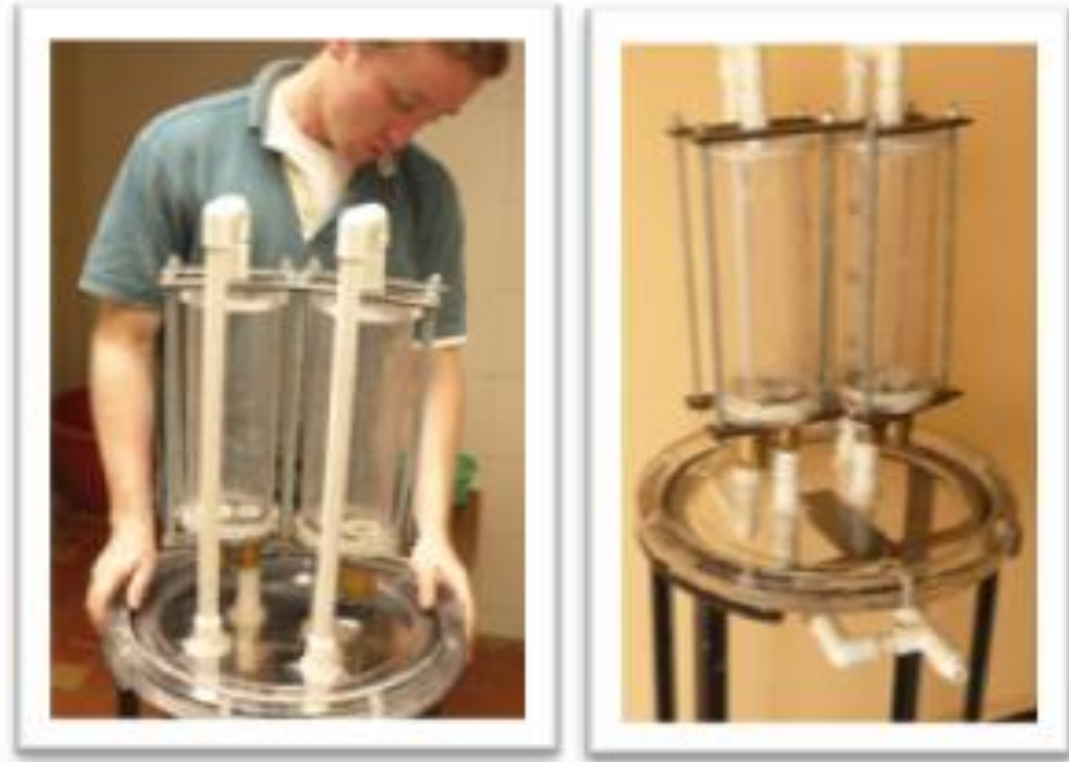
Figura 17. Montaje de la cámara de bombeo a la brida inferior
