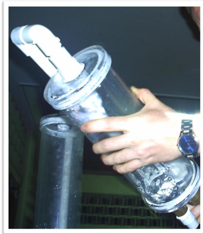
Figura 16. Construcción de las cámaras de bombeo
