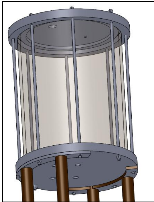
Figura 13. Detalle unión: estructura de soporte-tanque-bridas.
