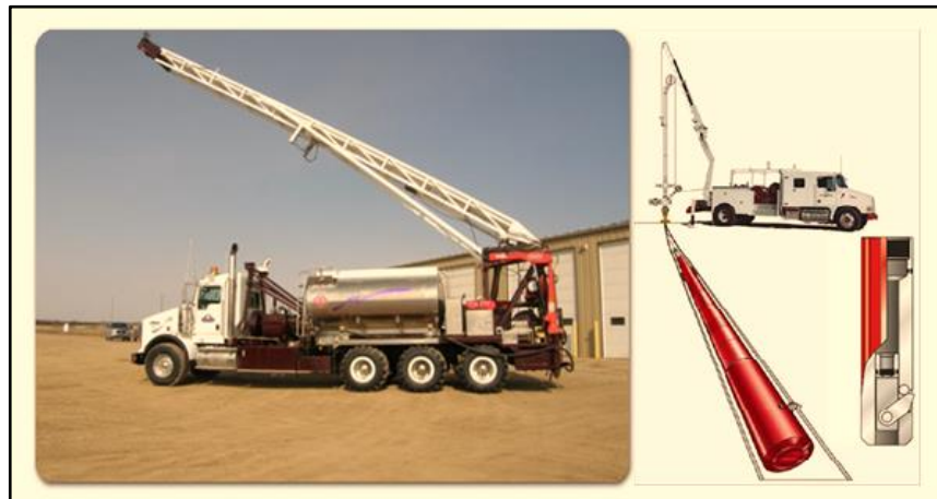
Figura 7. Sistema de Transporte de Carrete de Guaya Eléctrica
