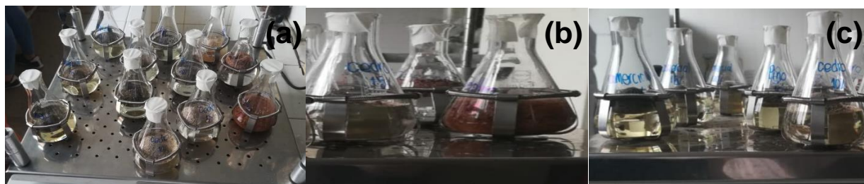
Figura 6. Prueba de flotabilidad de los aserrines de acuerdo con la norma ASTM F726-17. (a) Muestras de las tres clases de aserrín naturales y superhidrofóbicas sometidas a prueba de flotabilidad, (b) Muestras de aserrín natural sometidas a la prueba de flotabilidad, (c) Muestras de aserrín superhidrofóbico sometidas a la prueba de flotabilidad.
