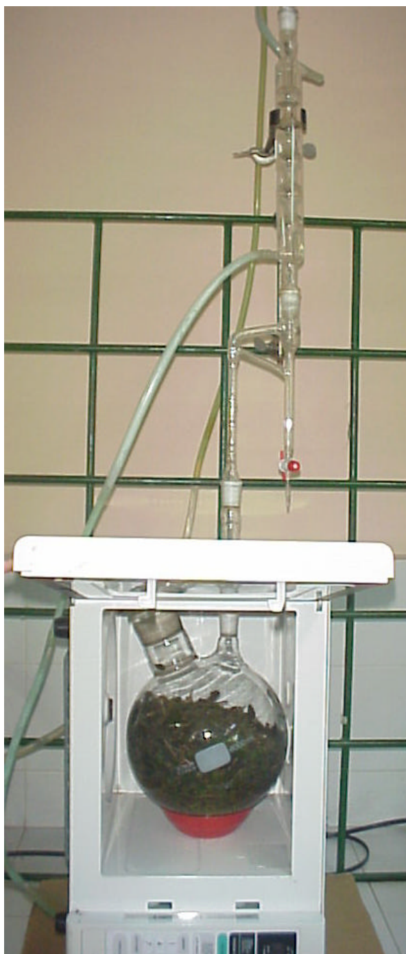
Figura 2. Montaje empleado para obtener los aceites esenciales por el método de hidrodestilación asistida por radiación de microondas (MWHD).
