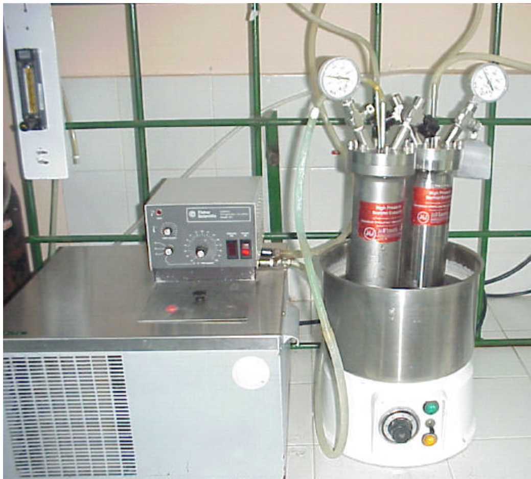
Figura 4. Extractor Soxhlet de alta presión para la obtención de extractos vegetales con fluido supercrítico (SFE).
