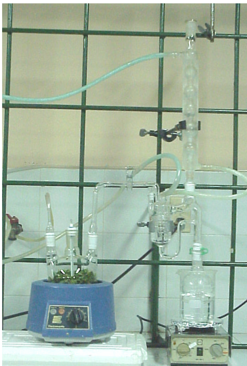
Figura 5 Equipo de extracción headspace dinámico (purga de espacio de cabeza con N_2 y trampa en solvente simultánea, P & T).
